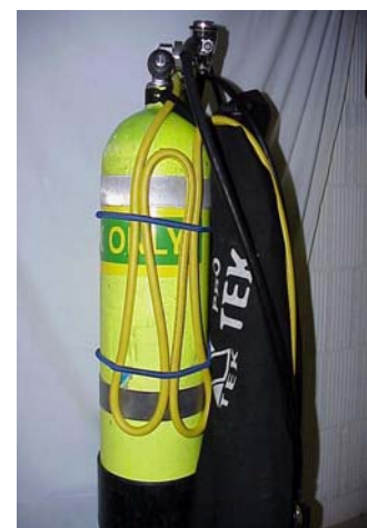
Langschlauch mit Befestigung; Mono-Gerät für Cavern-Bereich
