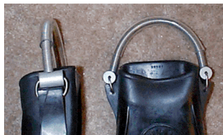
Stahlfedern statt Gummi-Flossenriemen
