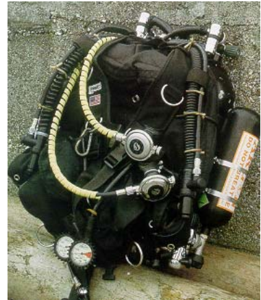
unabhängiges Doppelgerät, 2 Automaten, 2 Finimeter, Wings mit 2 Inflator, sep. Argon Flasche für Anzug
