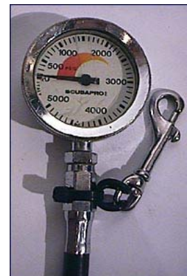
Befestigung des Finimeters (1 pro Flasche)
