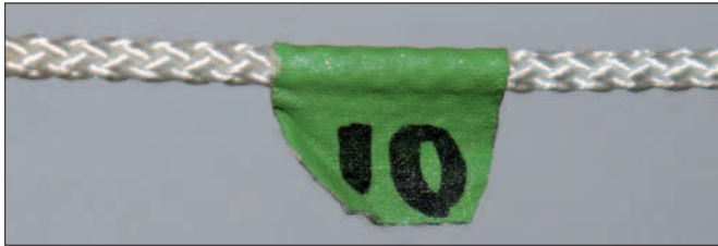
Abb. 4: Mit Klebeband markierte 3 mm-Führungsleine; unter der Entfernungsfahne befindet sich noch eine Farbmarkierung
