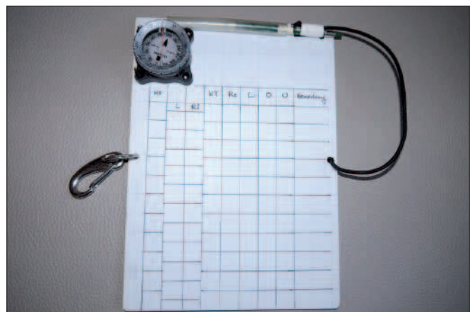
Abb. 6: Beispiel für eine Unterwasser-Messplatte zur Datenaufnahme mit Kompass, Tabelle und Bleistift in Halterung
