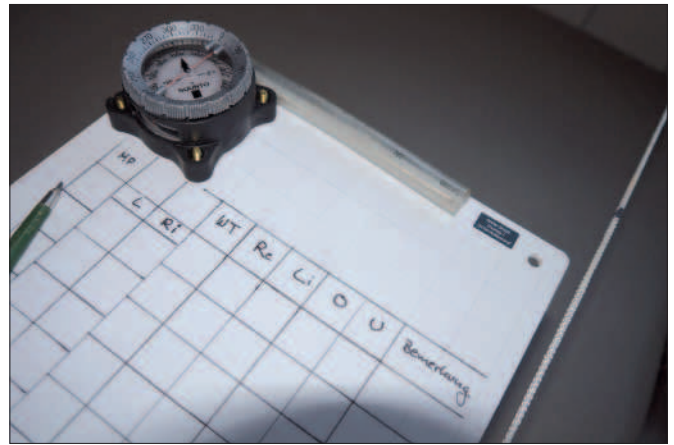
Abb. 5: Messplatte, angelegt an die Führungsleine
